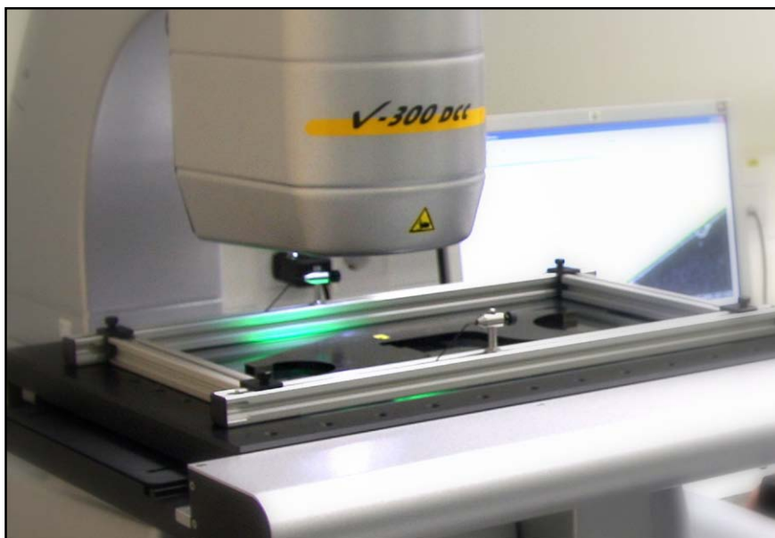
Slika 4. Izvedba kalibracije na optičnem merilnem stroju
