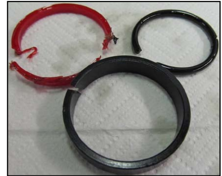
Slika 9. Izrabljeno in pretrgano poliuretansko tesnilo bata, drsni obroč brez deformacij že po 12 km dolžine opravljenih gibov batnice (konfiguracija št. 1)
