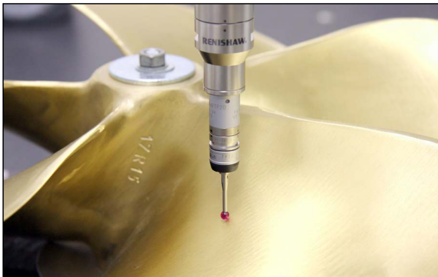
Slika 3. Preskus oziroma meritev ustreznosti na triosnem merilnem stroju
