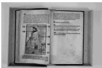
Slika 5: Meritve z metodo PIXE, izvedene na strani 8v (točke 12–17), stanje po konservatorsko-restavratorskem posegu. (Foto: Mateja Kotar, CKR ARS)
