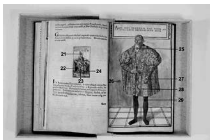
Slika 7: Meritve z metodo PIXE, izvedene na straneh 17v (točke 21–24) in 18r (točke 25–29), stanje po konservatorsko-restavratorskem posegu. (Foto: Mateja Kotar, CKR ARS)
