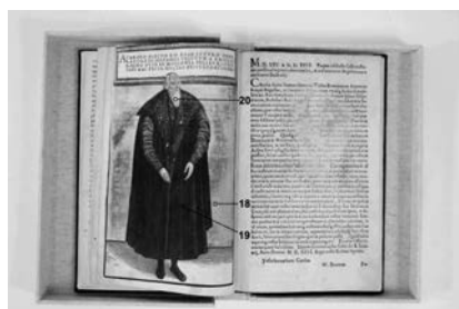
Slika 6: Meritve z metodo PIXE, izvedene na strani 12v (točke 18–20), stanje po konservatorsko-restavratorskem posegu. (Foto: Mateja Kotar, CKR ARS)
