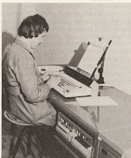
Tipkalna naprava KEY SET-30 v fotostavnem sistemu z držalom za rokopis, ekranom, ki prikazuje zadnjih 32 tipkanih znakov in perforatorjem, na katerem uporabljamo magnetni trak. Na teh napravah delajo fotostavci-perforisti
