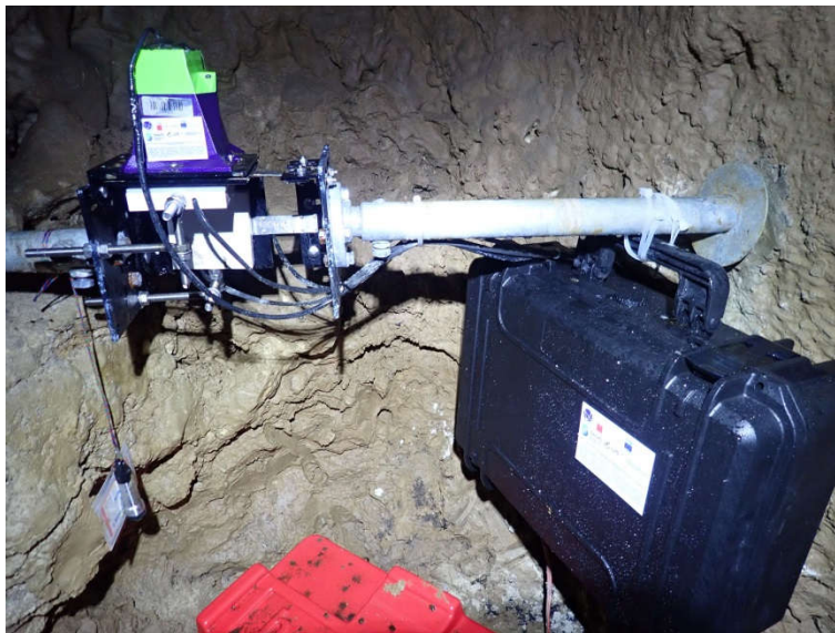
Slika 3 – tenziometer TM 72 za merjenje mikro-premikov v Kostanjeviški jami, foto S. Šebela.
