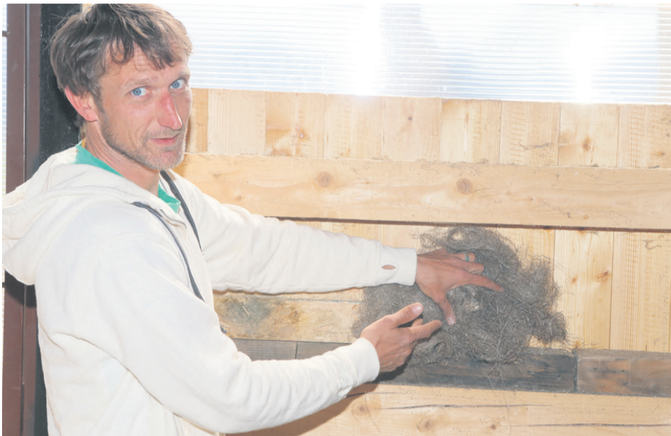
V konopljarne v Kapli od okoliških kmetov odkupujejo stebela industrijske konoplje, ki jih posušijo in obdelajo v posebnem postopku, da postanejo naraven izolacijski material, primeren predvsem za izolacijo zgradb. Na fotografiji je lastnik in direktor podjetja Tomaž Sušnik.
