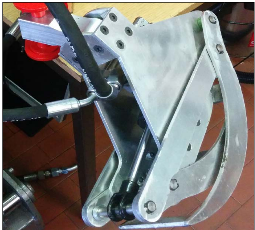
Slika 12. Izdelane klešče v zaprtem stanju 2
