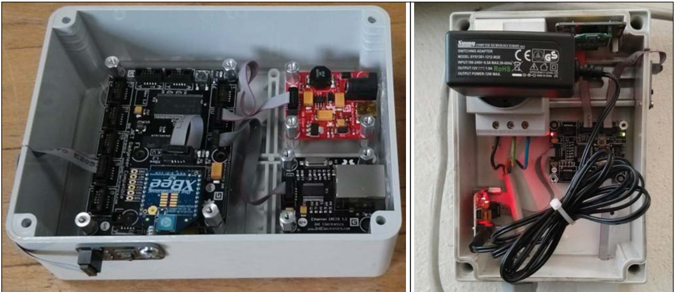
Slika 7. Pametna vozlišča brezžičnega senzorskega omrežja ZIGBEE za zajem podatkov iz elektroomare stroja
