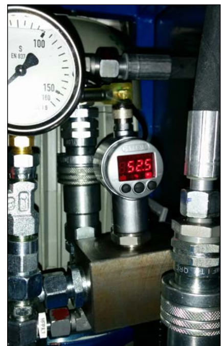
Slika 6. Elektronsko zaznavalo vlage, vgrajeno na hidravlični agregat roke
