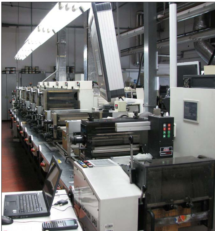
Slika 8. Tiskarski stroj Etipol 340 med predelavo; v ospredju slike je izstopni valj z ročicama za prijem papirja, upravljalne tipke stroja in ekran HMI s CPU-jem nad njimi. Temu sledijo postaje: najprej je postaja za odrez, nato postaja za laminiranje, v ozadju pa 6 tiskarskih postaj.
