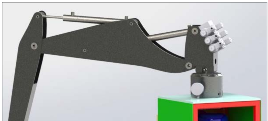
Slika 11. Geometrijska 3D-zasnova hidravlične roke
