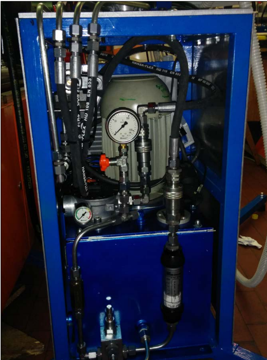
Slika 5. Izdelan prenosni hidravlični agregat hidravlične roke
