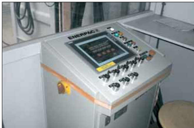
Centralna PLC-krmilna enota s štiritočkovnim sinhronim hidravličnim dvižnim sistemom
