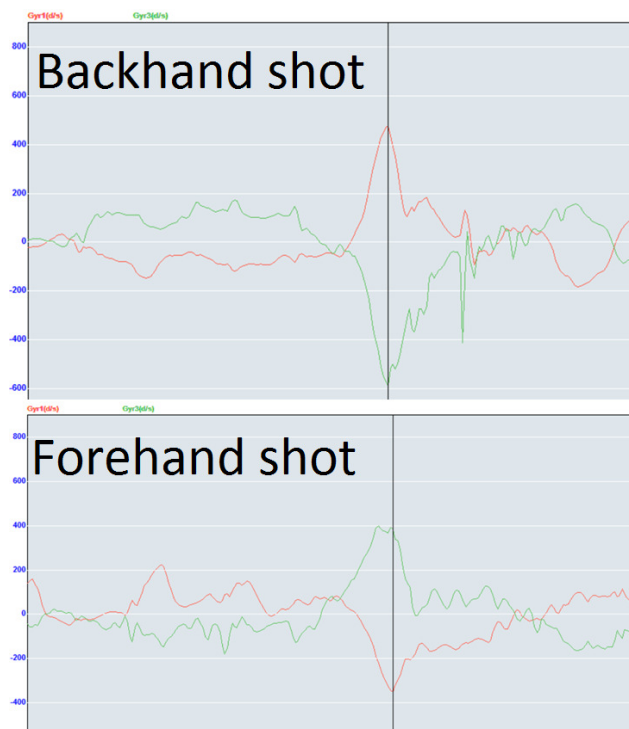
Slika 3: Razlika v vrednostih kotnih hitrosti za os 1 in 3 za žiroskop pri backhand in forehand udarcu.
