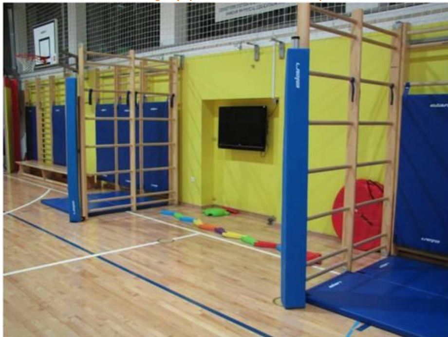
Slika 20: Odmični letveniki omogočajo povsem nov izkoristek te opreme in oboda telovadnice
