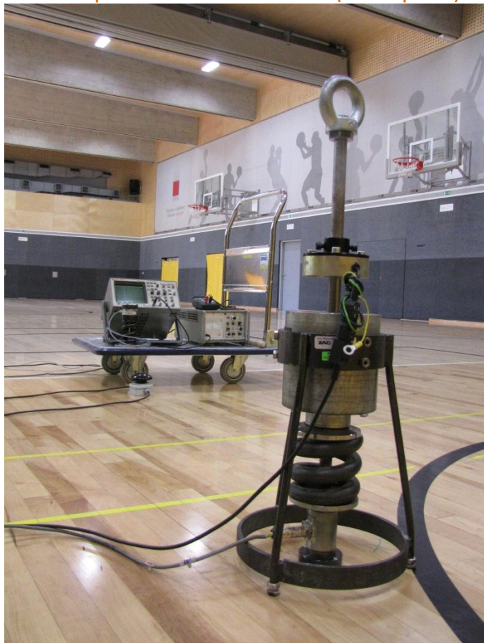
Prikaz 34: Naprava za meritev ublažitve udarca (umetni športnik)
