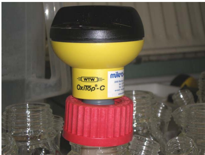
Slika 18: Merilna glava za merjenje sprememb tlaka v steklenicah (9.10.2008)
