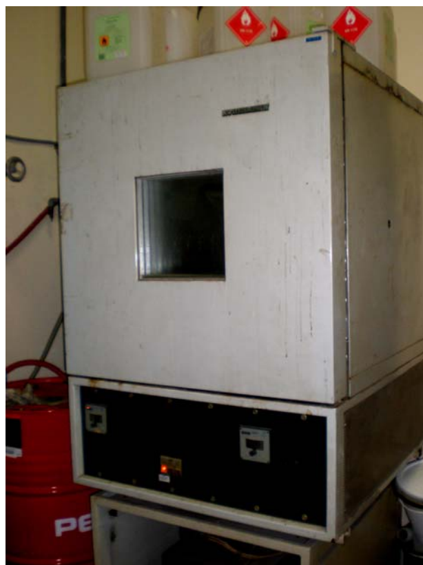
Slika 9: Termostatirana komora, v kateri je potekalo kompostiranje (9.5.2008)
