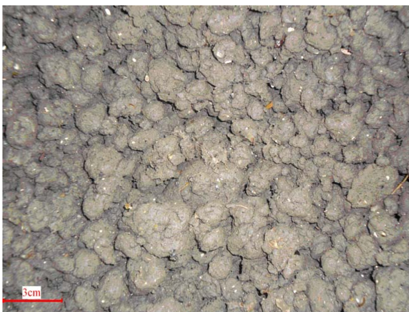
Slika 2: Dehidrirano (kontinuirna aksialna centrifuga) surovo blato z 21 % suhe snovi (CČN Radovljica, 11.12.2008); povprečni premer grudic je 1,5 cm
