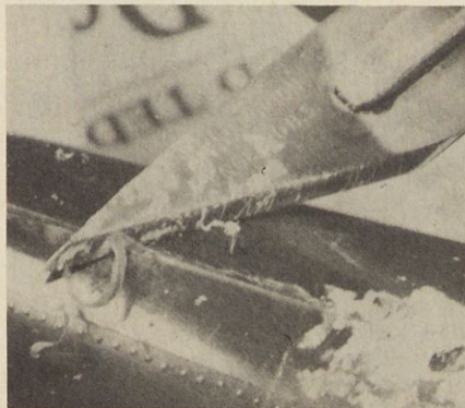
Odstranjevanje že strjenega lepila in stopljene plastike na stičišču obeh polovic trupa letala
