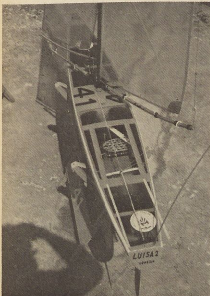
Pogled pod krov jadrnice Benečana Sabadina odkriva zanimivo konstrukcijo mehanizma za upravljanje z jadri.
