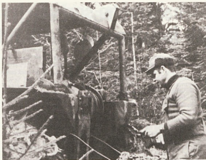
Traktorist Miha Fabjan pri pripravi vitla na traktorju Fergusonu za spravilo lesa v Jelendolu, TOZD Gozdarstvo Podturn. (Foto: J. P.)
