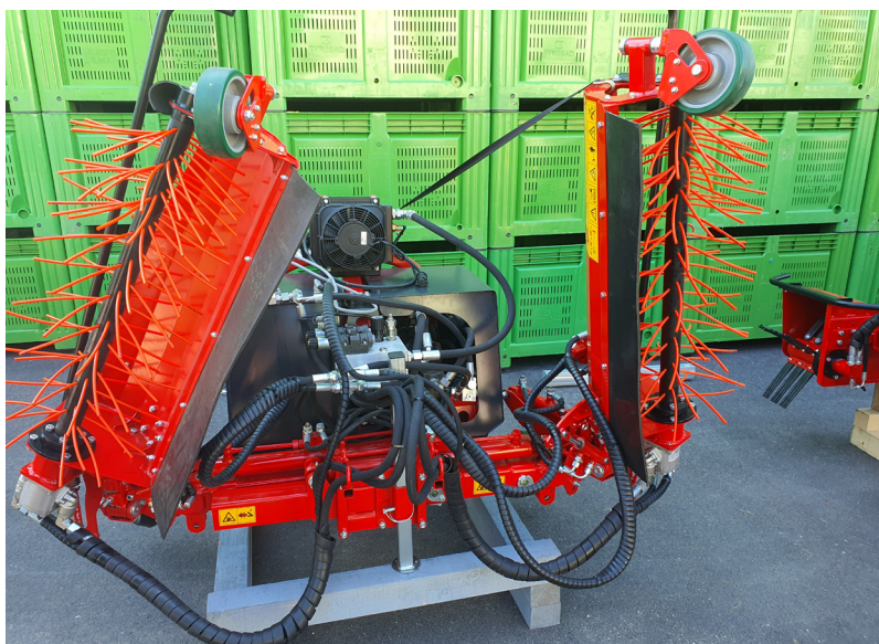
Slika 46: Nitkar za obdelavo tal pod drevesi
