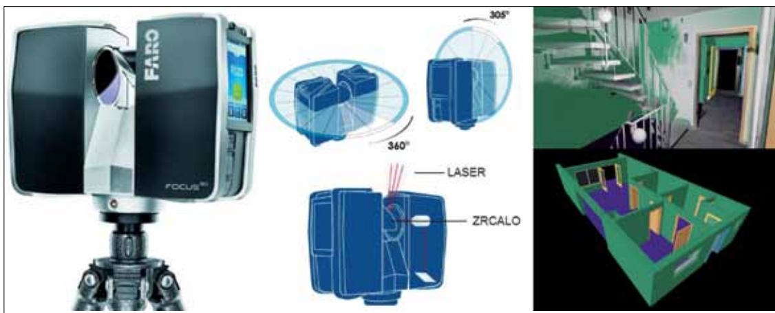
Slika 2: Model FARO Focus3D, ki je bil predstavljen na konferenci in prikaz zajema oblaka točk z regeneriranjem realnega stanja ter priprave informacijskega modela za nadaljnje projektiranje.
