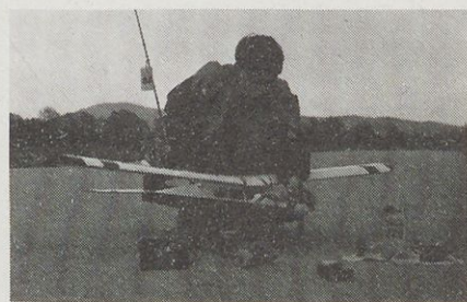
4. Zelo trdno grajen začetniški motorni model TRAINER 40 z razpnetino 1,5 m (lesen, s krmili za smer, višino, nagib in motor; priporočen motor pribl. 5 cm 3 ); za začetno šolanje je mogoče krilci tudi fiksirati v nevtrali. Pred modelom vidimo še nekaj pomožne opreme: (z leve) električni zaganjalnik z akumulatorjem, merilnik vrtljajev, zaščitni naprstnik, posoda z gorivom in ročna črpalka za gorivo.
