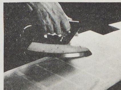
Slika 8. Lepljenje folije na rebra krila
