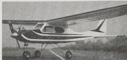
2. Začetniški motorni model CHARTER z razpnetino kril 1,5 m (lesen, s krmili za smer, višino in motor ter vodljivim prednjim kolesom; priporočen motor pribl. 5 cm 3 )
