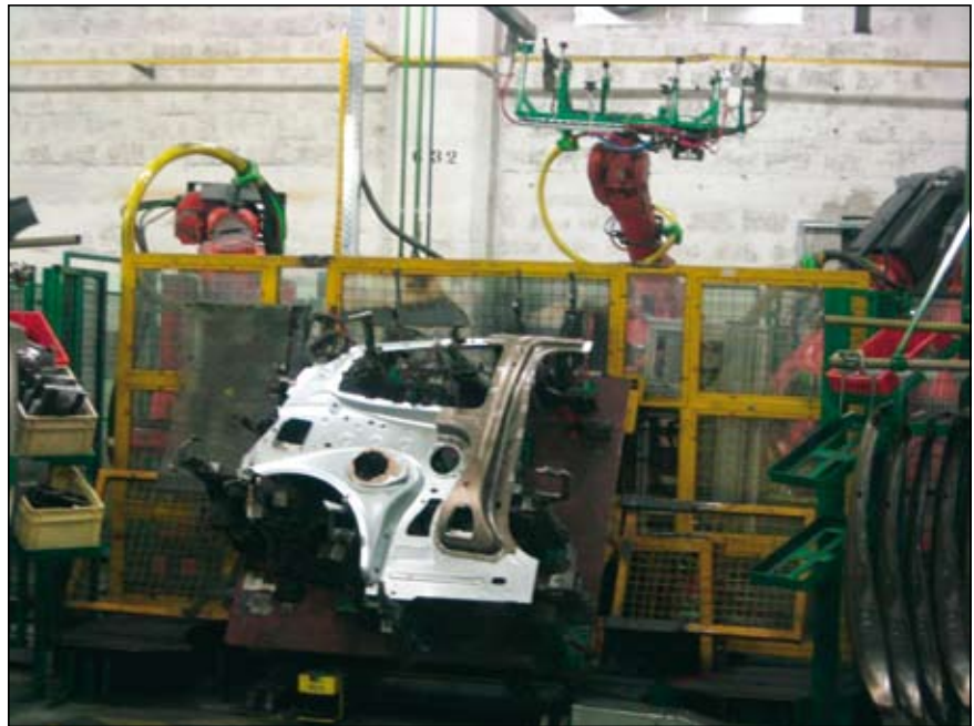
Slika 1. Pogled na delovno mesto robotske varilne celice za predsestavo notranjih oblog stranice karoserije OP 40 s strani vlaganja kosov
