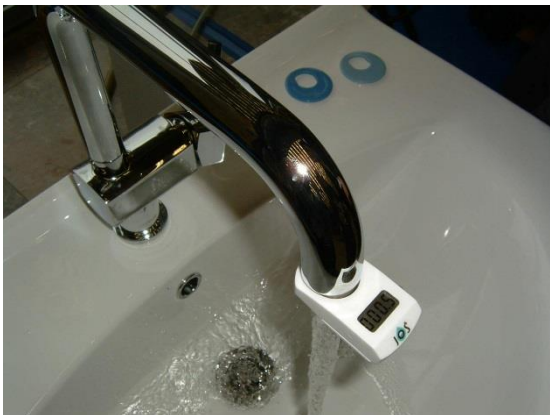
Slika 1: Učenci in dijaki v vsakem trenutku vidijo koliko vode so porabili (foto: Jože Cvetko).
