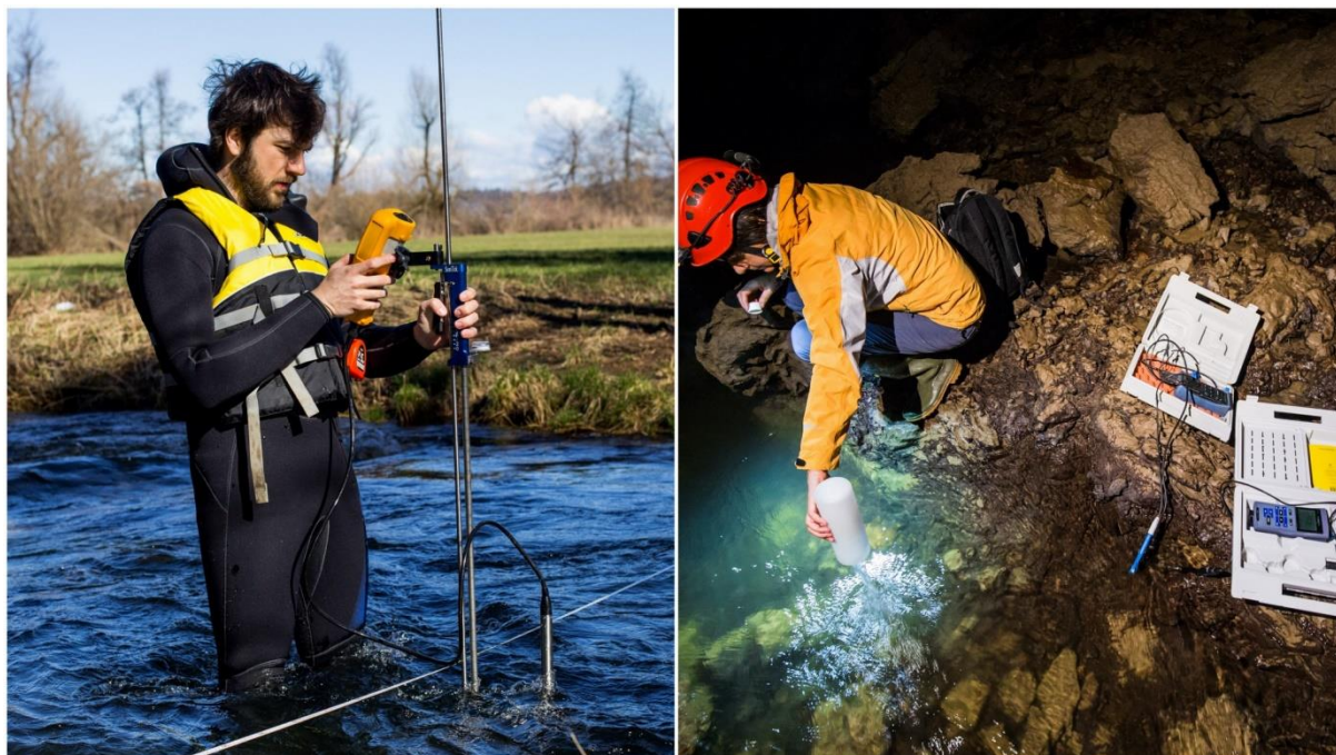
Slika 2: Prikaz več vrst uporabljenih metod. Levo merjenje pretokov, desno vzorčenje vode za kemijske analize.
