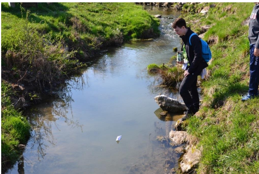
Slika 2: Merjenje hitrosti vodnega toka z ladjico. (Fotografija: Maja Novak Rupnik, 2019).
