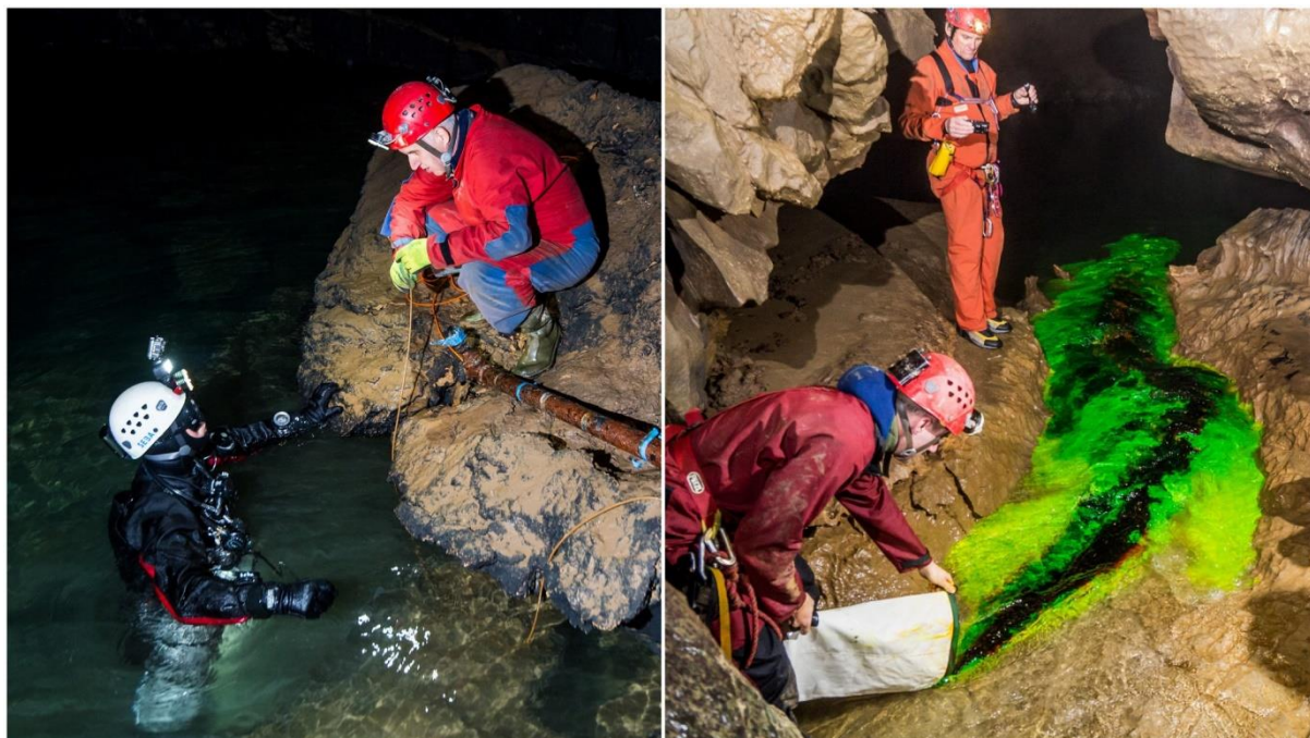
Slika 1: Prikaz več vrst uporabljenih metod. Levo speleološke raziskave s potapljanjem, desno ugotavljanje vodnih zvez s sledilnim poskusom.
