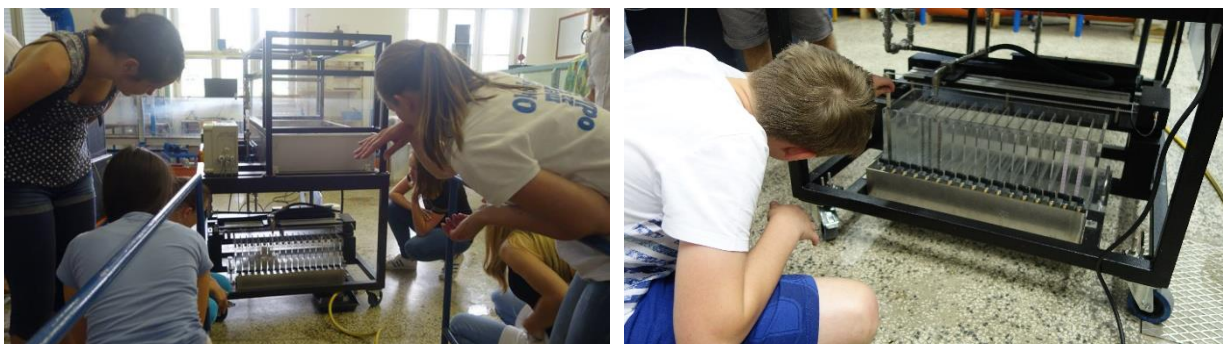
Slika 4: Razlaga delovanja modela površinskega odtoka (levo) in meritve višine vode v posameznih zbirnih posodah (desno).
