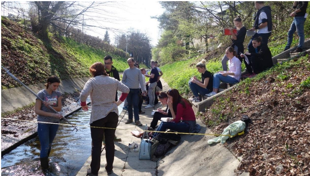
slika 9: Meritve globin vode za določitev površine prečnega prereza vodotoka in pozneje za določitev pretoka. (foto: Kludija Sapač).
