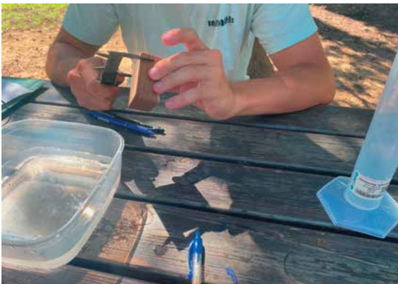
Slika 10: Merjenje s kljunastim merilom.
