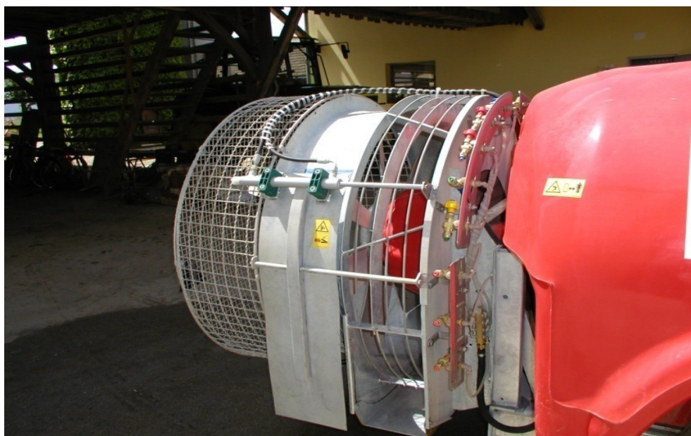
Sodoben hmeljarski pršilnik z vgrajenimi šobami za zmanjševanje zanašanja ter nameščeno enostransko zračno zaporo (foto: G. Leskošek)
