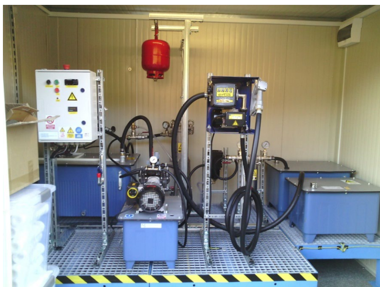
Slika 8: Pogled v notranjost kontejnerske postaje za čiščenje odpadnih jedilnih olj (vir: Kmetijski inštitut Slovenije, Oddelek za kmetijsko tehniko in energetiko)
