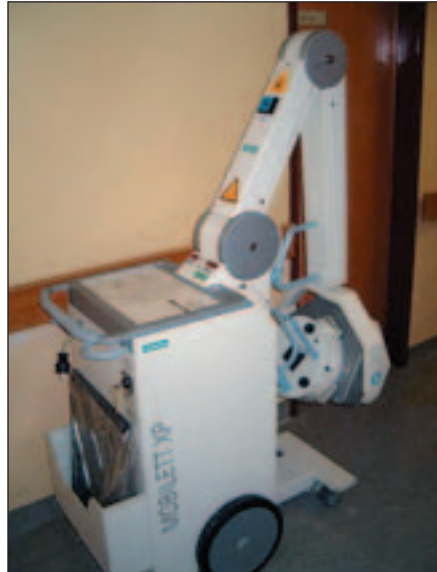
Slika 1. Premični rentgenski aparat za slikanje prsnih organov pri ležečih bolnikih.
