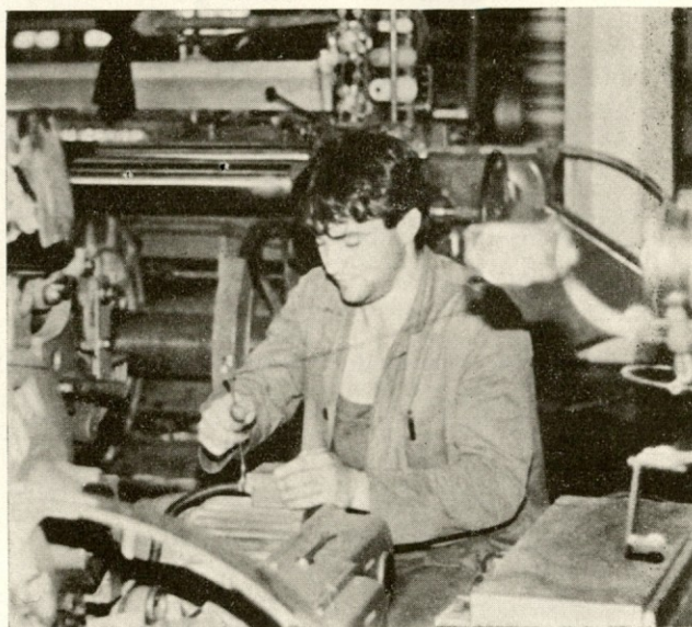
Električarja Matjaža Korošca smo našli pri čiščenju in preizkušanju tiskanih vezij na stroju Somet.
