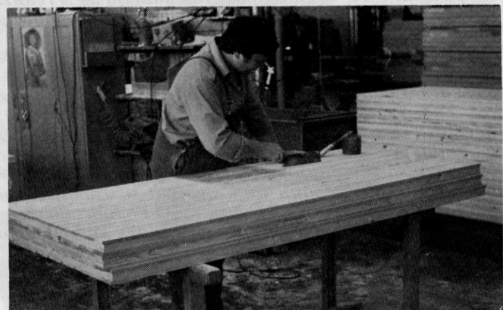
Da so vhodna in garažna vrata kvalitetna, je treba vse smolne kanale ter izpadajoče grče zakrpati
