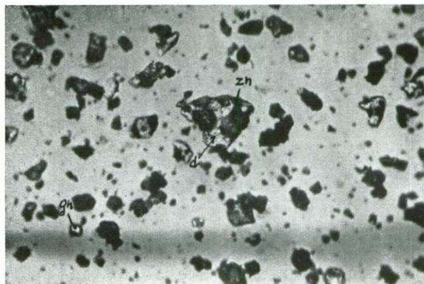
3. sl. Mežica—Topla. Zraščanje sfalerita (zn) z dolomitom (d) v flotacijskem materialu. Ultropak, 200 × povečano.
