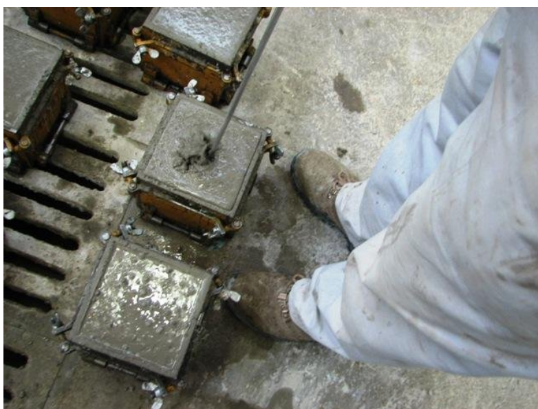
Slika 28: Vpihovanje zraka za nastanek zračnih žepov
