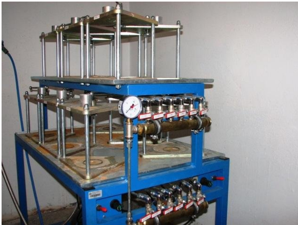
Slika 20: Naprava za preizkus vodotesnosti
