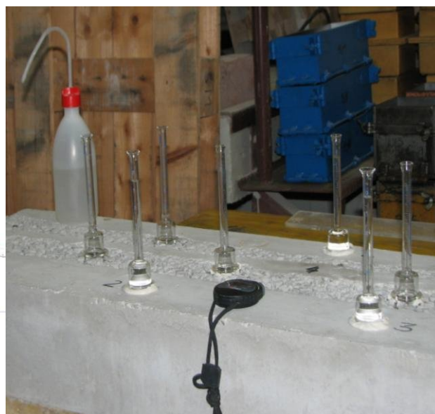
Slika 56: Shematični prikaz določevanja vodovpojnosti [18]
