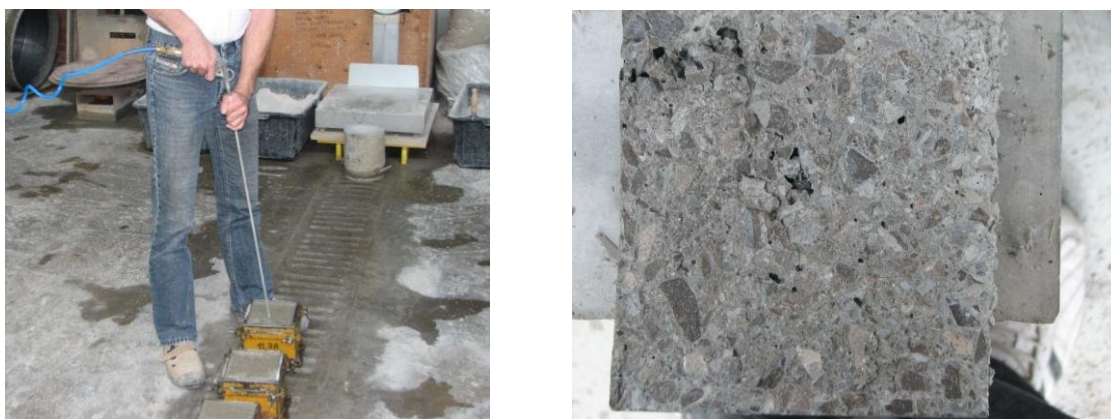
Slika 83: Prikaz dovajanja zraka preskušancu pod pritiskom in por v notranjosti preskušanca
