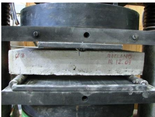
Slika 32: Upogibna obremenitev ploĳe iz katere smo izvrtali vaĳje
