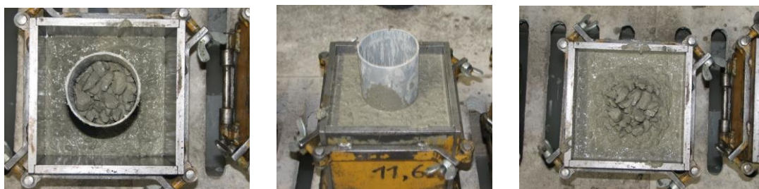
Slika 79: Priprava grobozrnatih gnezd v naših preskušancih
