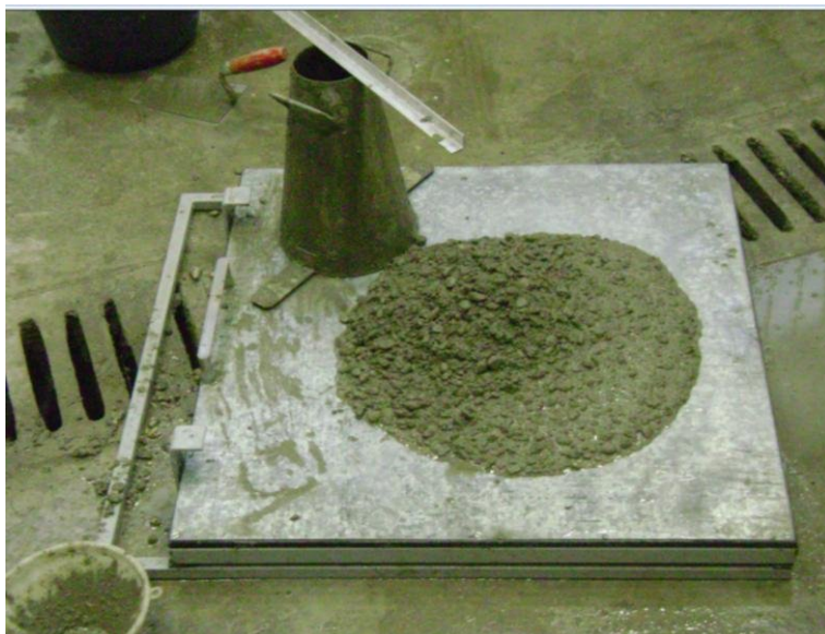
Slika 21: Merjenje poseda na lahkogradljivi betonski mešanici.
