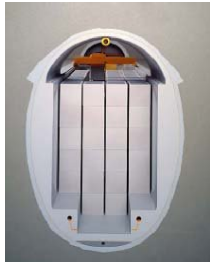
Slika 9: Primer polnjenja rova z AB vsebniki.
