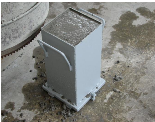
Slika 62: Prikaz poseda betonske mešanice v standardnem kalupu po SIST EN 12350-4 in razredi zgoščitve po SIST EN 206-1
