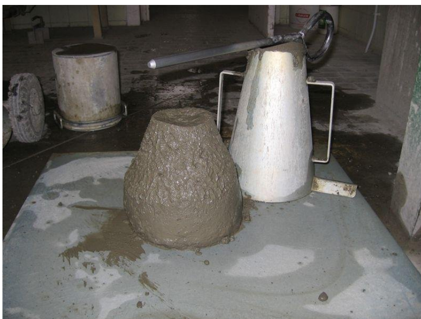
Slika 9: Kovinski konus in poseden betonski vzorec.
