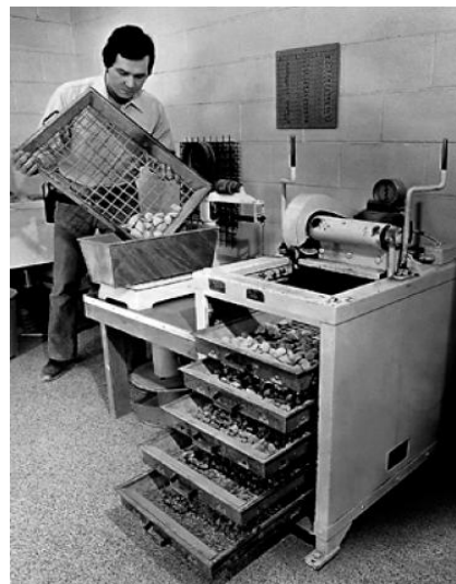
Slika 20: Sejalna analiza agregata [2]
