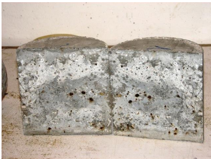
Slika 26: Primer razklanega vaĵa po površini hladnega stika
