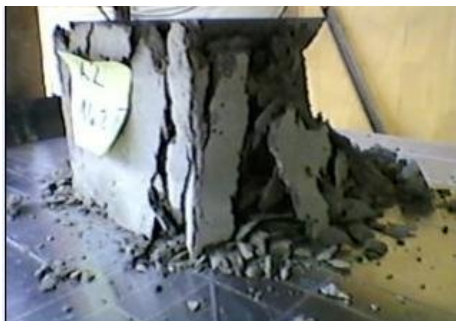
Slika 25: Preizkus tlačne trdnosti betona
