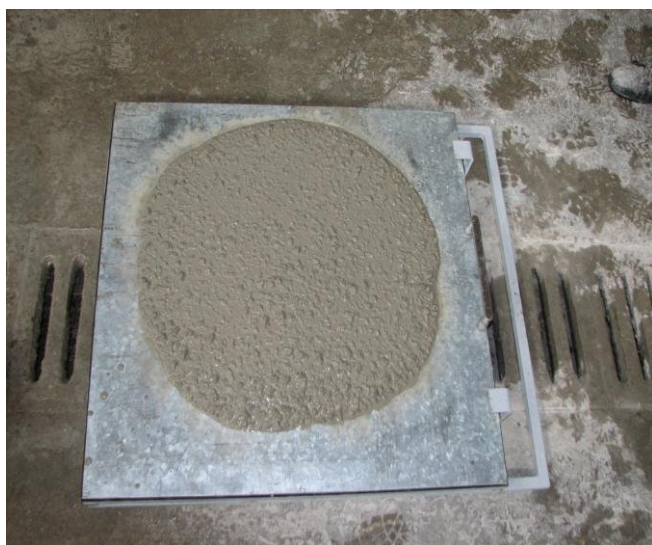
Slika 60: Prikaz razleza po SIST EN 206-1 in razredov
