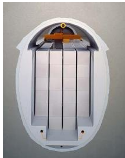
Slika 9: Primer polnjenja rova z AB vsebniki.
