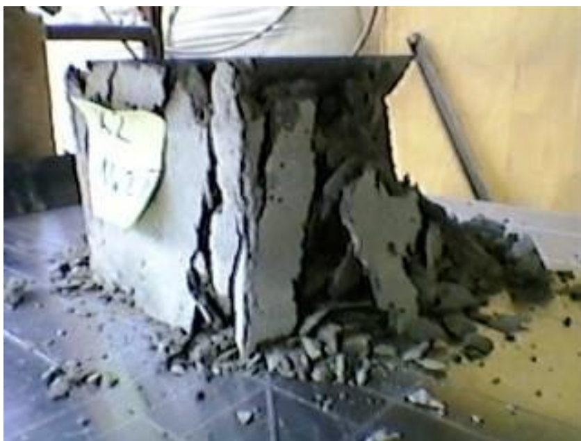
Slika 16: Primer tlačnega preizkusa kocke
