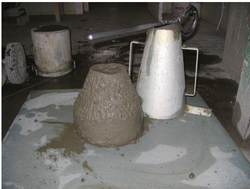
Slika 9: Posed betonskega stožca.
