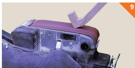
Spodnji del nog zbrusimo do polne črte.
