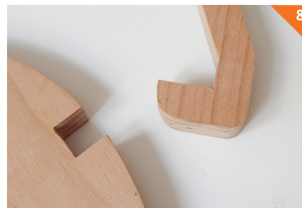
Zajede na glavni plošči zbrusimo, da se prilegajo nogam.
