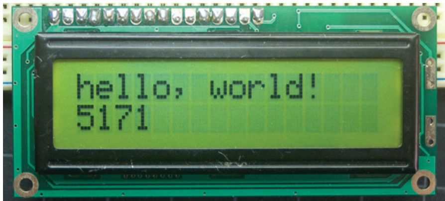
LCD-prikazovalnik, ki ga dobimo v razširjenem kompletu Arduino UNO. (Vir: https://www.arduino.cc/en/uploads/Tutorial/lcd_photo.png )
