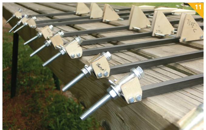
Aluminijasta cevka in vijak tvorita drsni ležaj.
