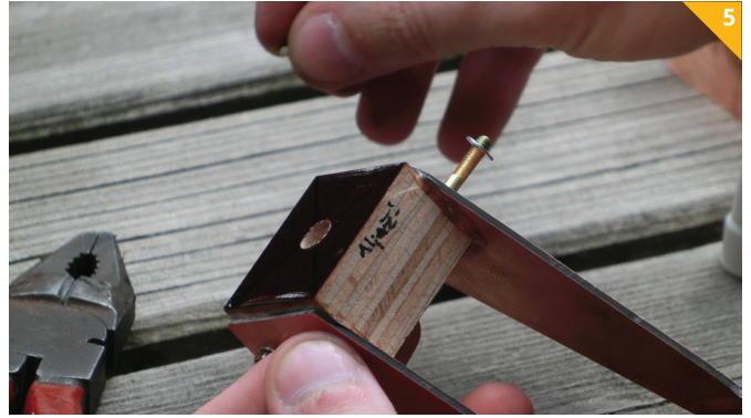
Daljši vijak ali palica z navojem, kamor se pritrdi kroglični zglob.
