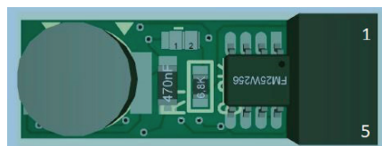
Razporeditev komponent na zgornji strani tiskanega vezja
