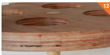
Debelejšo palico vlepimo v glavno ploščo.
