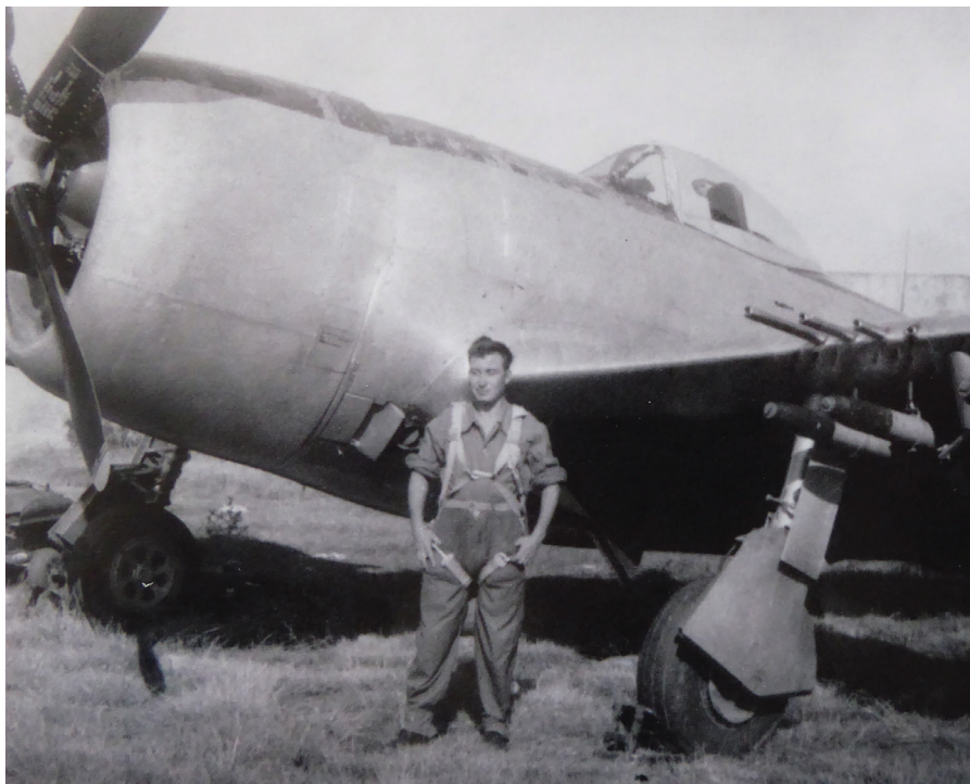
Pilot Albin Pibernik pred oboroženim thunderboltom v Cerkljah ob Krki leta 1953. Na bojno delovanje pripravljeno letalo ima pod krili nameščene nevodene izstrelke vrste HVAR-5. Pibernik je bil med prvimi piloti 83. lovskega polka, ki je s thunderboltom izvedel bojno raketiranje. (Zbirka Albina Pibernika)
