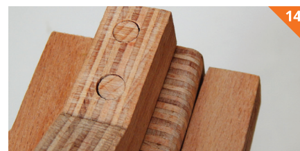
Tanjše palice srednjega dela pobrusimo do nog.
