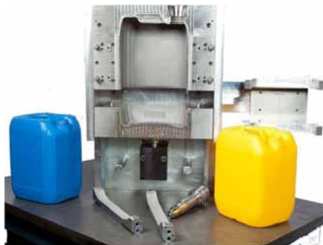
To je pri klasičnih orodjih omogočeno z odprtini, skozi katere zrak uhaja s pomočjo vakuumu. Zrak se tako odstranjuje le lokalno, uporaba vakuumu pa lahko na končnem izdelku pusti sledi.
