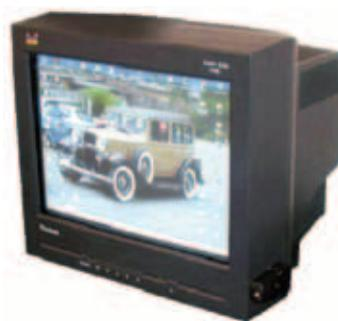
› V sprednjem delu zaslona se v steklo dodaja stroncijev in barijev oksid za absorpcijo rentgenskih žarkov.
