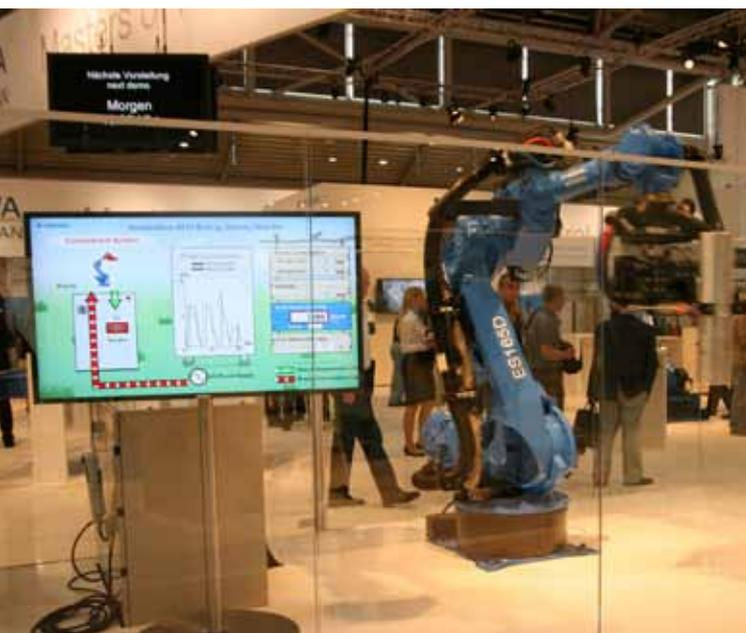
» Prikaz učinkovitosti in varčnosti robota z inteligentnim sistemom krmiljenja in povrnitve energije pri zaviranju
