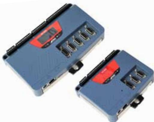
» Nova pozicijska krmilnika Trio Motion MC 405 in MC 403. Zanimivi ohišji imata ulito kovinsko osnovno ploščo za optimalne EMC-lastnosti ter kombinacijo vijčnih priključkov in standardnih D-konektorjev za enostavno priključevanje. Pri obeh izvedbah lahko izbiramo med modelom za krmiljenje servoosi ali nekoliko cenejšim modelom za koračne osi.
