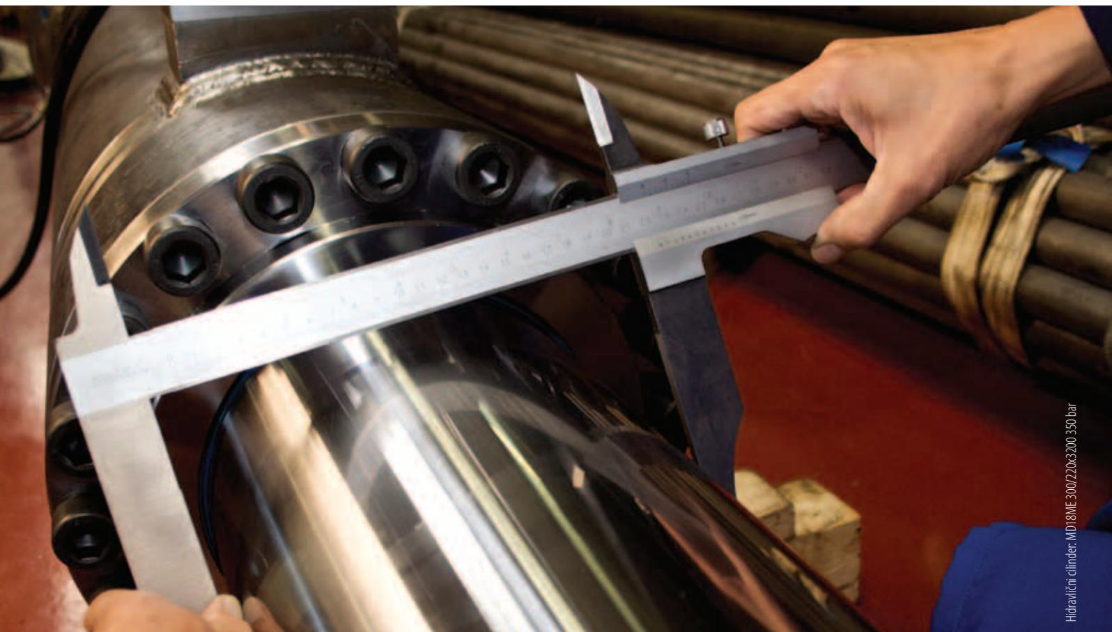
Hidravlični cilindri: MD18ME 300/220x3200 350 bar
