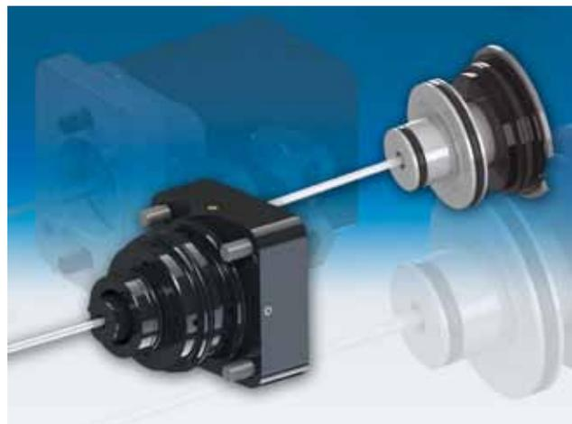
Tudi pri pnevmatski izvedbi Z107910/... z vgradnim cilindrom v vpenjalni plošči so uporabljeni modularni notranji deli nastavitvenega mehanizma. Na voljo so štiri velikosti za različne premere igel z variabilnim hodom, možna pa je tudi pritrditev bata z zapornim obročem. V primeru okvare se tako lahko odklopi posamezno gnezdo, ne da bi bilo treba zaustaviti celotno proizvodnjo.
