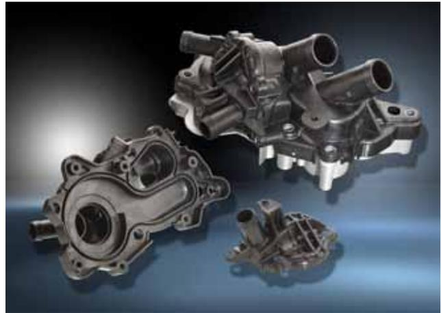
na. Zato so linije hladnega spoja lahko prestavili na tiste dele ohišja, ki so pod manjšo obremenitvijo. Dolgoročno tesnjenje komponente je bilo zaradi vseh obremenitev tudi velik izziv, ki so ga premagali s simulacijskim orodjem ULTRASIM®. Tako so lahko napovedali lezenje materiala in konstrukcijo komponente ustrezno optimizirali.
