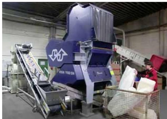
Drobniki VEGA lahko v eni uri predelajo od 300 do 1500 kg materiala. Na voljo so dva premera rotorja (282 in 434 mm), tri dolžine (540, 1080 in 1620 mm) in dve vrsti lopat (koničaste in kvadratne). Posebna razporeditev lopat na rotorju omogoča delovanje le ene lopate naenkrat. Zato je nadzor dodajanja materiala boljši, hrup manjši, količina drobcev v peletih pa manjša.
