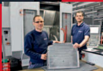
» Vodja proizvodnje Pascal Chemier (desno) in vodja oddelka za rezkanje Robert Müller z zahtevnim rezkanim delom – vakuumsko vpenjalno ploščo za nestabilne obdelovance
