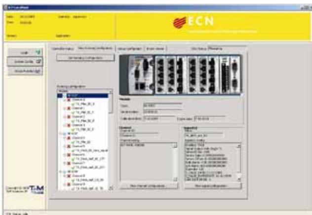
› Slika 3: Gostiteljska aplikacija z grafičnim uporabniškim vmesnikom za konfiguracijo ohišja, enot, kanalov in signalov
