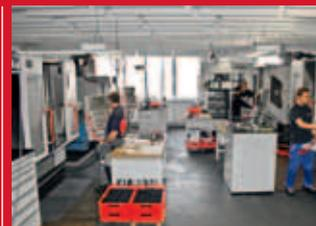
» Center za rezkanje v podjetju Hein & Oetting je trenutno opremljen s CNC-obdelovalnimi centri C 800 V, C 600 U in C 30 U (2x).
