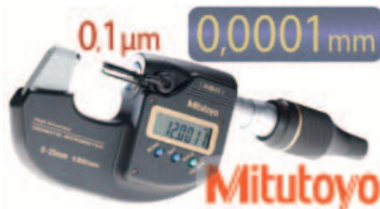
Za izjemno precizne meritve so zasnovali snemljiv toplotni ščitnik, zelo tog okvir in mehanizem za konstantno silo merjenja 7–9 N. Območje merjenja je 0–25 mm, mikrometer ima tudi podatkovni izhod.
