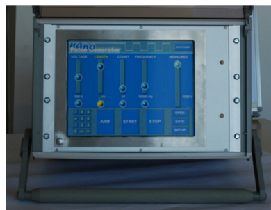
Slika 2: Izdelani nanopulzni elektroporator
