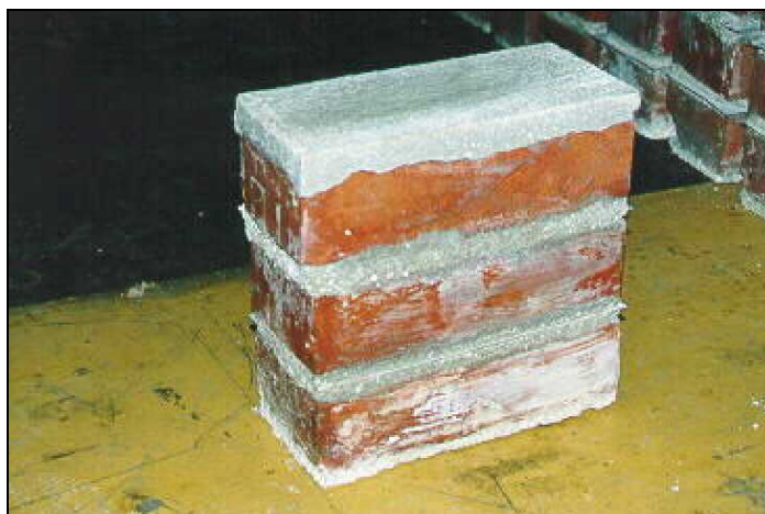
Slika 157: Zidani vzorec z vgrajeno vodoneprepustno zaporo
