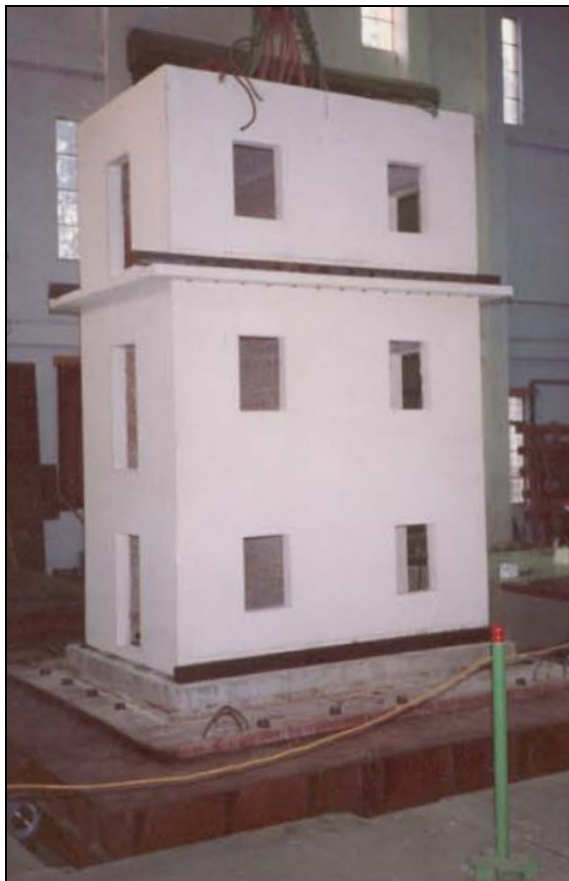
Slika 74: Model konstrukcije pred preiskavo (Nikolic-Brzev, 1993)
