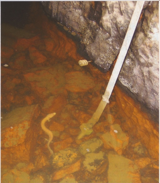
Meritve raztapljanja s pomočjo treh apnenčastih ploščic v Pivki jami (na jekleni palici je nameščen merilnik vodostaja). Fotografija: Mitja Prelovšek.
