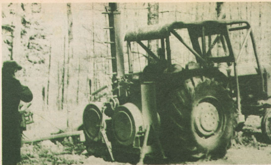
Dvobobenski vitel Igland za spravilo lesa na krajših razdaljah — do 250 m. Nosilnost do 1500 kg. Primeren za spravilo drobnejših sortimentov (redčenja) — navzdol ali navzgor. Učinek do 20 m 3 /dan. Vitel montiran na traktorju IMT 558. (Foto: M. Bajt)
