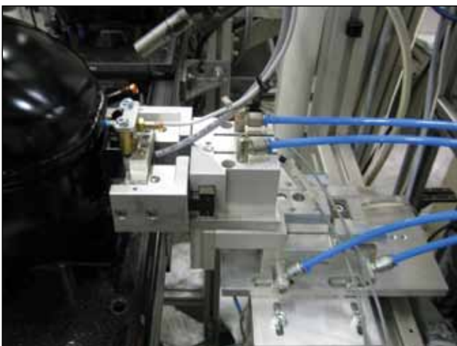
Slika 2. Električni priključni sistem brez drsnega trenja
