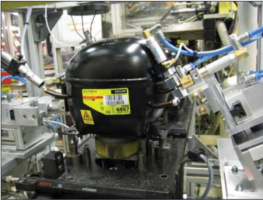
Slika 1. Diagnostični sistem za končno kontrolo kompresorja na proizvodni liniji
