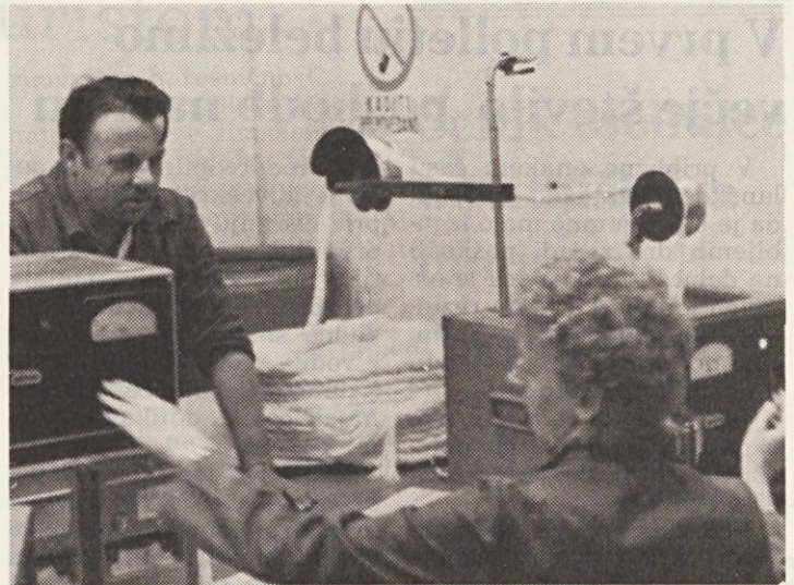
Nace Senica se redno zanima za rezultate aparata USTER, saj po tem ve, če stroji v predpredilnici dobro delajo ali pa je potrebno še kaj popraviti.
