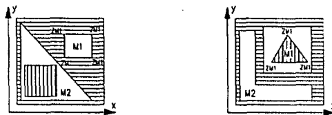
a) Presečni mnogokotnik M1 luknja ploskve M2 b) Luknja ploskve M1 presečni mnogokotnik M2
