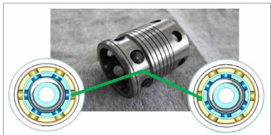
Slika 32 : Prikaz dodanega utora na notranjem batu in prežez CAD-mođela s poravnanimi in neporavnanimi izvrtinami po obodu
