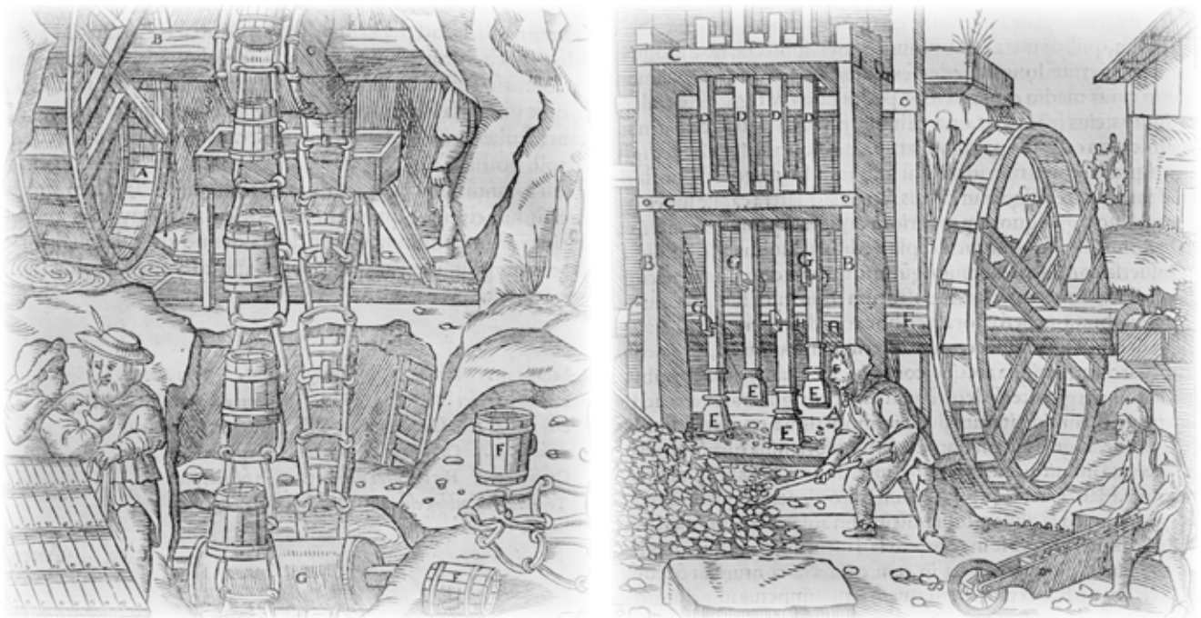
Slika 2 : Uporaba vodnega kolesa za pogon verige z vedri in za pogon drobilnika v srednjem veku; Georgius Agricola's De Re Metallica (1556); [2], [3]
