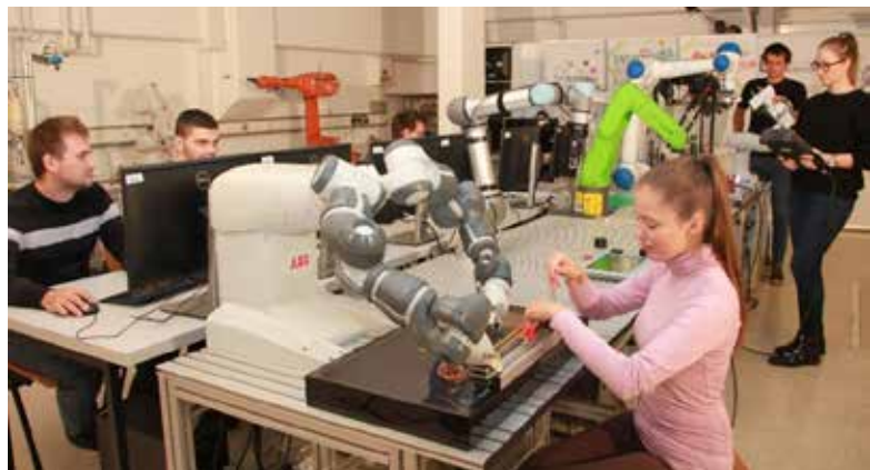
Center za sodelujočo robotiko združuje najnovejše robote: ABB YuMi, Universal Robots UR5e, Fanuc CR7i, Yaskawa FC10D in Franka Emika Panda. (Foto: Sebastjan Šlajpah)
