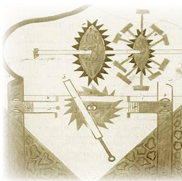
Slika 10 : Al-Jazarijeva dvojna, recipročno delujoča črpalka z ročično gredjo; originalna risba (levo) in CAD risba črpalke (desno); [18]
