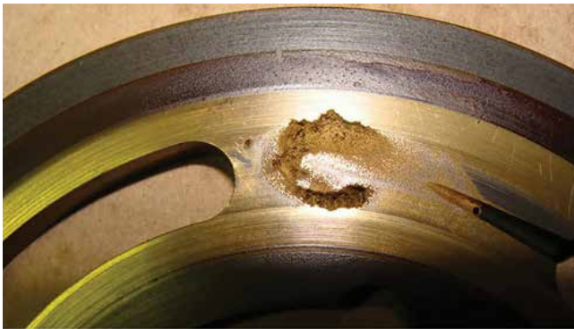
Slika 4 : Posledica kavitacije - poškodovana ventilska plošča aksialne batne črpalke
