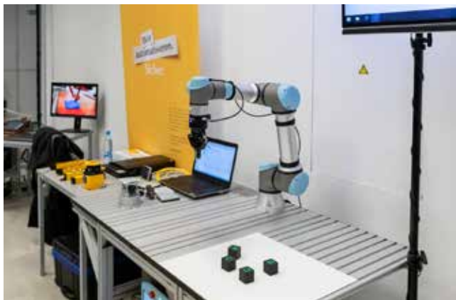
Robot UR5e proizvajalca Universal robots v aplikaciji prepoznavne objektov z robotskim vidom, nadzora kvalitete ter testiranja trka za standard ISO/TS 15066:2016 (Foto: Milan Simčič)
