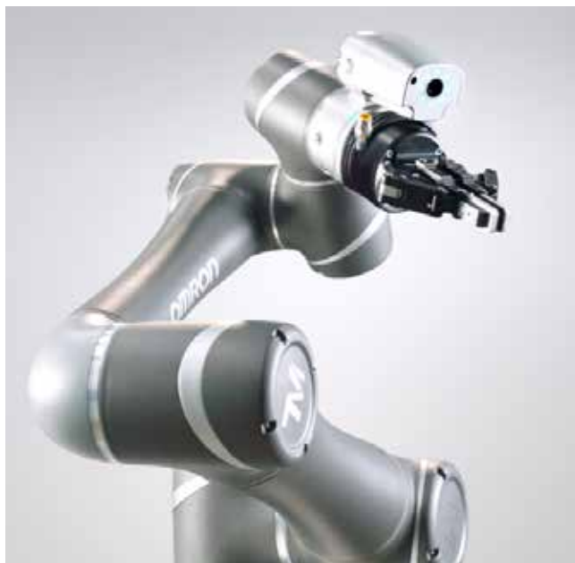
Slika 1 : Kolaborativni robot Omron serije TM s serijsko vgrajenim strojnim vidom in prijmalom
