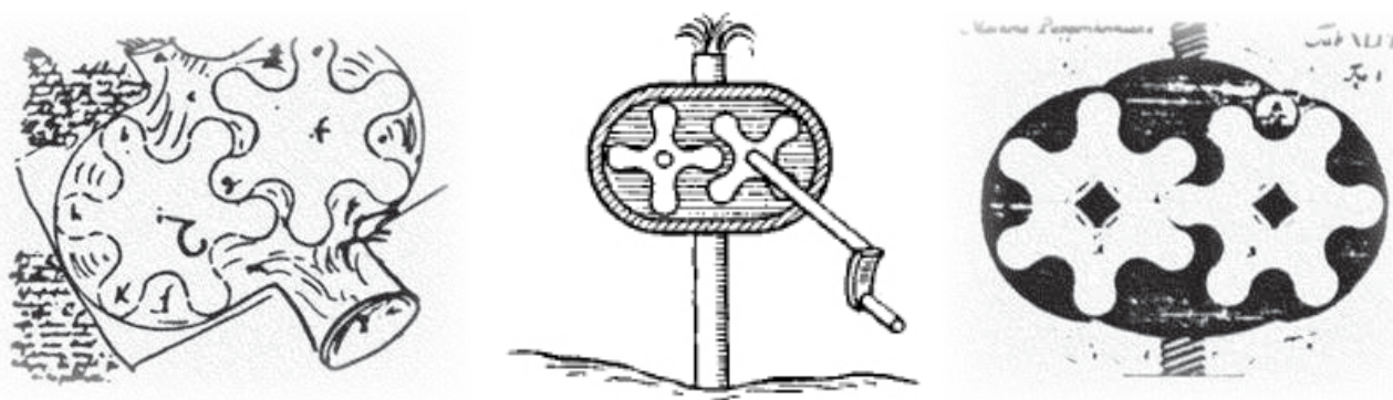
Slika 12 : Prve izvedbe zobniških črpalk; Keplerjeva (levo), Leurechonova (sredina) in Pappenheimska/-ova (desno); [19], [21]
