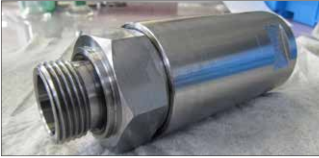
Slika 35 : Razviti prototip dvopotnega tokovnega ventila s tlačnim kompenzatorjem
