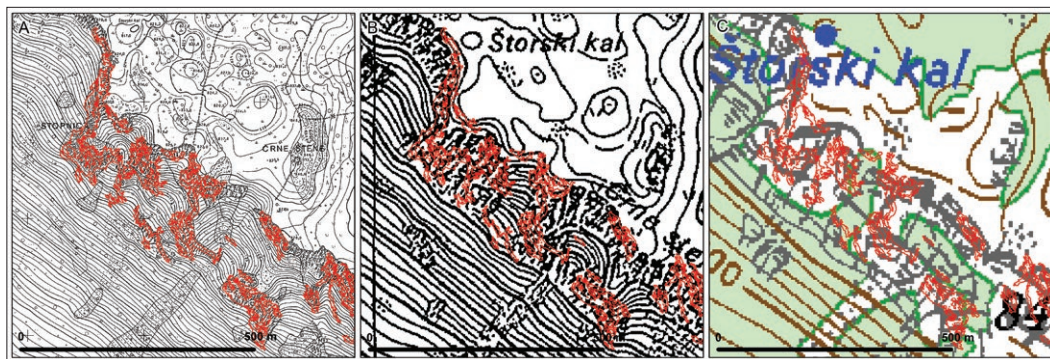
Slika 8: Primer treh preglednih kart z vrisanimi izvori kamenja, določenimi na podlagi mejnih vrednosti naklonov pobočja iz lidarskega digitalnega modela. A: TTN v merilu 1 : 5000, DPK v merilu 1 : 25000 ter DPK v merilu 1 : 50000
