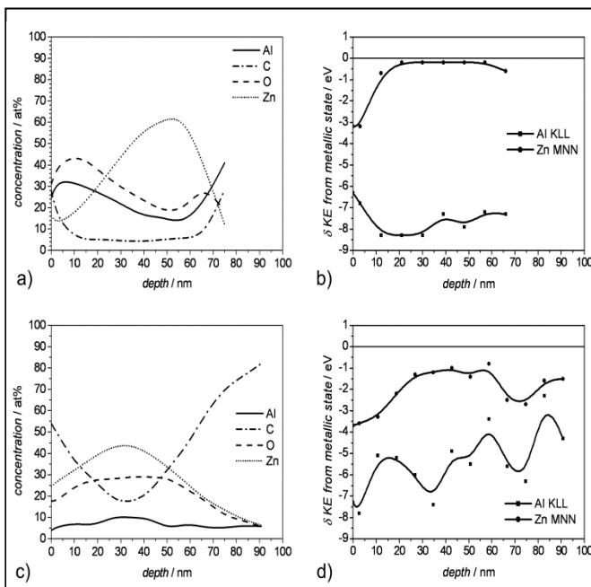
AES koncentracijski profili za Al, Zn, O and C za vzorce s povečano (a), in normalno (c) vsebnostjo Al; odstopanja pri kinetičnih energijah Augerjevih elektronov za prehode Al KLL in Zn MNN od ustreznih vrednosti za kovinska Al in Zn v odvisnosti od globine za vzorce s povečano (b), in normalno (d) vsebnostjo Al.
