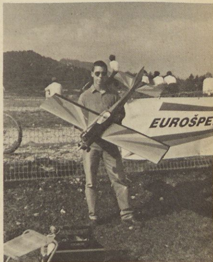
Janez Nebec je med nastopom pokazal, da dobro obvlada svoj akrobatski model Circus. Podatki o modelu: razpon krila 1500 mm, dolžina 1200 mm, masa 3,5 kg, motor Webra 8,5 cm 3 .
