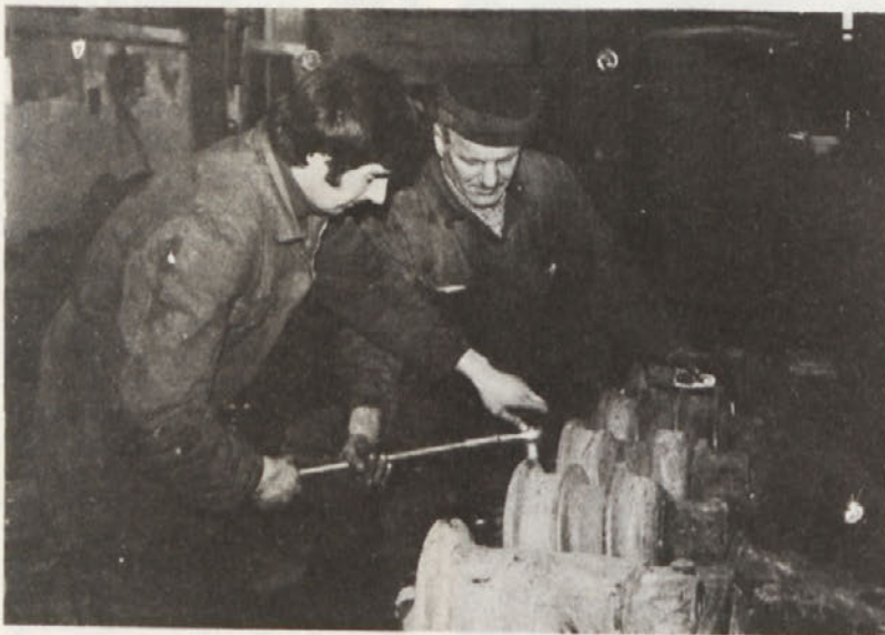
Delavca iz TOZD Mehansko kovinski obrat v Novem mestu sta se lotila popravila gosenic buldozerja
