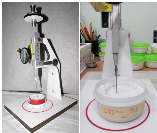
Slika 4.26: Vicatova metoda, merjenje končnega časa vezanja injekcijskih mešanic z modificiranim kalupom (levo) in apneno skodelico (desno).
