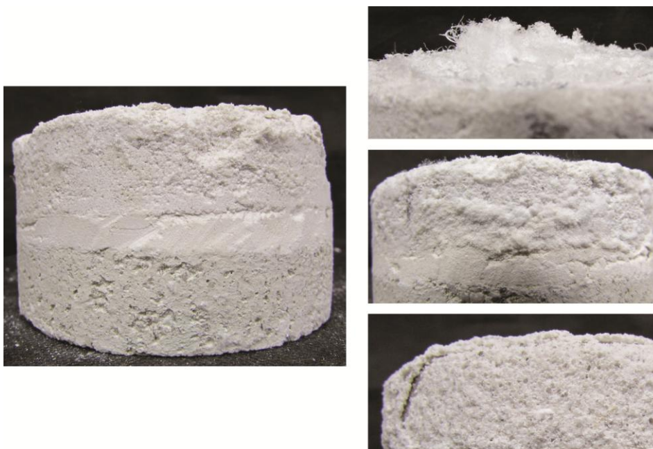
Slika 4.34: Pospešeno staran sendvič z mešanico L 1 S 2 B 1 PCE (levo). Akumulacija in eflorescenca soli na zgornji (desno zgoraj) in stranski (desno srednje) ploskvi finega ometa. Razpadanje ometa zaradi eflorescence vodotopnih soli (desno spodaj).
