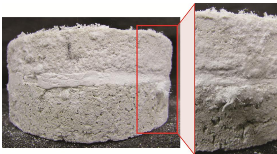
Slika 4.35: Pospešeno staran sendvič z mešanico RC (levo). Akumulacija in eflorescenca soli med mejno ploskvijo grobega ometa in RC mešanico (desno).
