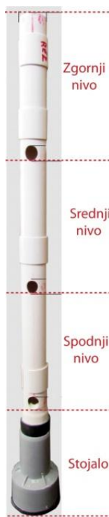
Slika 3.6: Cilinder za preverjanje stabilnosti injekcijskih mešanic.
