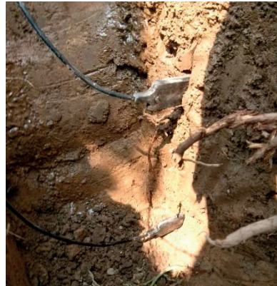
Slika 2: Horizontalno vstavljena senzorja Decagon 10HS na globinah 20 in 40 cm
