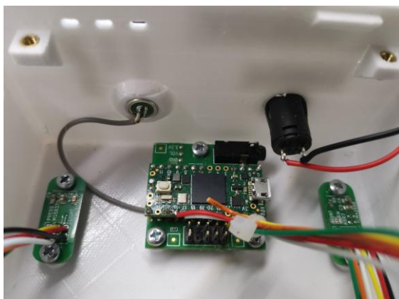
Slika 3: Umestitev merilnika hrupa v napravo DEMOS.
