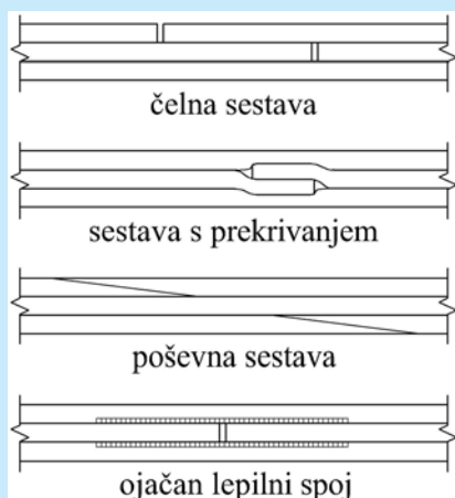
□ Slika 4. Načini dolžinskega spajanja furnirja za proizvodnjo LVL /11/
