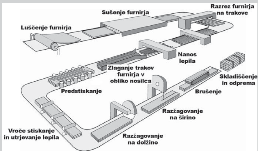
□ Slika 7. Shematski prikaz proizvodnje PSL /13/
