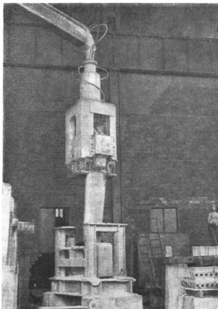
Slika 5 Rezanje korenine ingota Fig. 5 Cutting ingot foot
