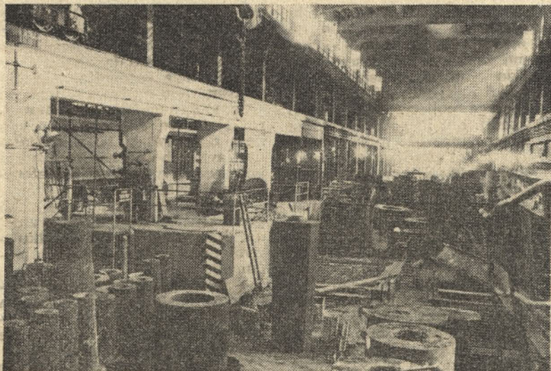
V okviru rekonstrukcije livarne I je bilo najprej dograjeno postrojenje elektro-indukcijske peči
