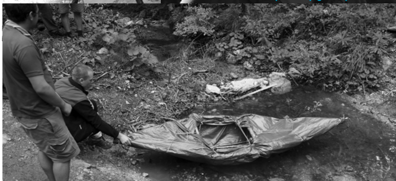
Doma narejen kanu - konstrukcijo iz lesk oblečemo v šotke ter plastificirano ponjavo, spoje zatesnimo z lepilnim trakom.
