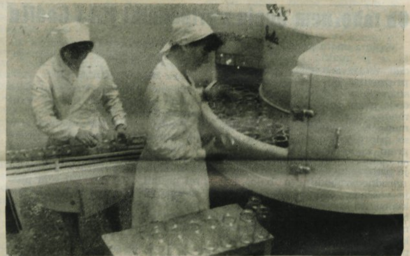
V novi zgradbi sodobna oprema: Stroj za pomivanje kozarcev in tekoči trak
