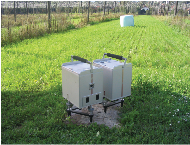
Slika 4: Primer stabilizacije gravimetrične točke Radmirje GT15 iz osnovne gravimetrične mreže (foto: M. Kuhar, 2006).
