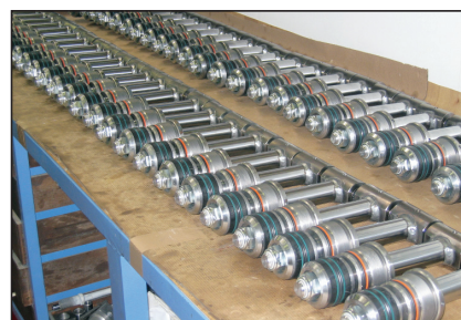
Hidravlični valji pred montažo
