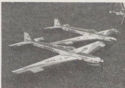
A- in B-model "Saphir 2" Norberta Matta iz Liechtensteina (29. mesto, motor YS-120-AC, propeler APS 14 x 13,5", gorivo HOPE/Carbulin).
